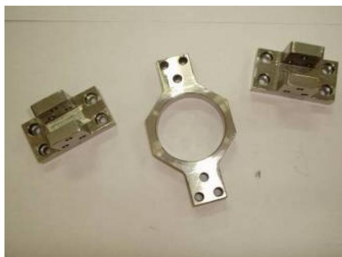
Figura 13 Foto da célula de carga e dos suportes usinados.
